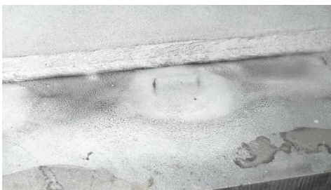
Das Prüfergebnis war negativ. Es wurden keine Risse gefunden. (Quelle: Finke)
