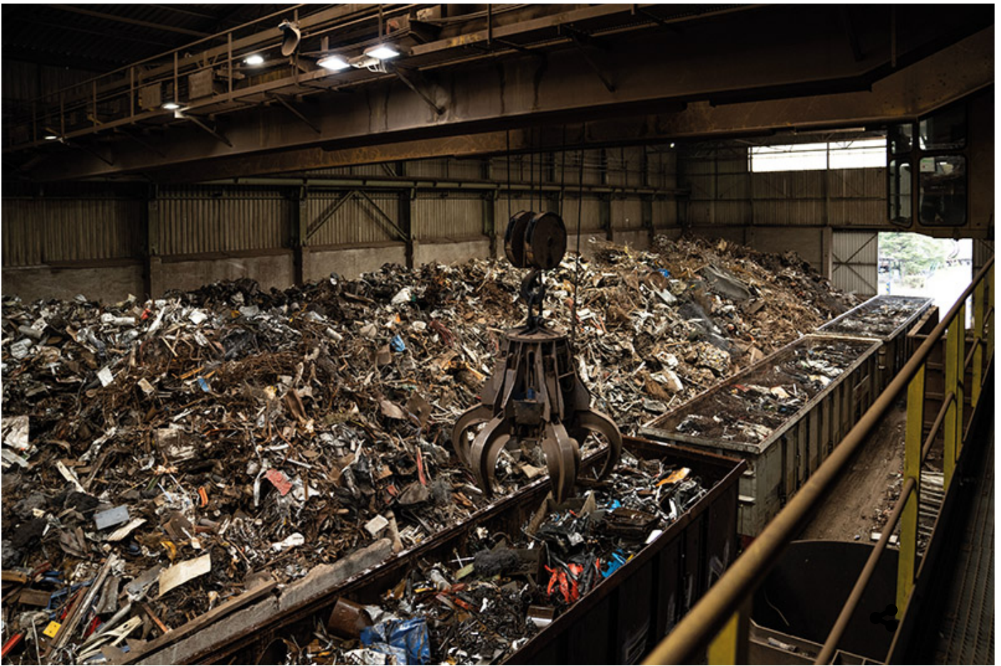
Eisenschrott als Basis für neuen Stahl – umgesetzt in der Marienhütte in Graz.
